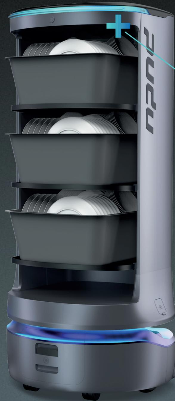
Großes Fassungsvermögen und Traglast: 60 kg Tragfähigkeit / 120 l Volumen, 4 Ablagefächer
